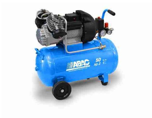
Compressore aria lubrificato ABAC "V36/50 Serie Pro" 50l 3hp. Elettrocompressore ABAC Codice 1129981051 Gamma PRO monostadio, coassiale bicilindrico a V a trasmissione diretta con pressione di utilizzo fino a 10 bar. Questo articolo fa parte della linea PRO di Abac ed è studiato per un utilizzo professionale che richiede altre prestazioni. Il compressore è caratterizzato.....**Altro**
