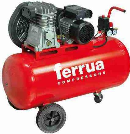
Compressore aria lubrificato Ferrua 100l 2hp. Compressore aria a cinghia con collettore alettato per favorire lo scambio termico, ed assicurare il raffreddamento dell'aria. Carter ad olio, albero in ghisa sferoidale, biella antiusura e volano plurialettato per un miglior raffreddamento del gruppo pompante. Ideale per un impiego gravoso e continuo è lo strumento ideale per hobbisti,.....**Altro**
