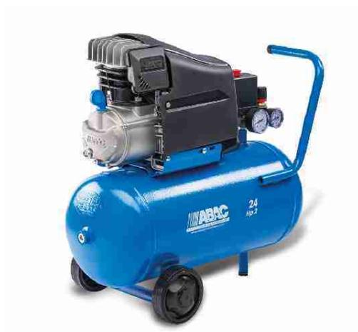
Compressore aria lubrificato ABAC "Pole Position L20" 24l 2hp. Elettrocompressore ABAC Codice 1129100021 a pistoni gamma Line L20 monostadio, trasmissione diretta, lubrificato con pressione di utilizzo fino a 10 bar. Compressore Abac Pole Position L20 linea che rappresenta la fascia media dei compressori Abac, dotato di motore elettrico da 2 cavalli trasmissione diretta con capacità.....**Altro**
