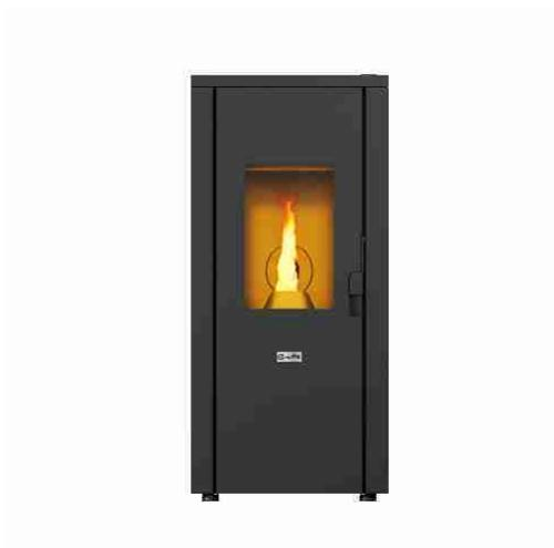
Stufa a pellet ermetica Canadian Stove "Design Evo" nero 8,3 kW. Stufa a pellet ermetica con rivestimento in acciaio e potenza nominale di 8,3 kW, capace di riscaldare ambienti fino a 215 m<sup>3</sup>. Presenta un consumo orario del pellet di 1,9-0,8 kg/h ed un rendimento di 91,6 %. La stufa a pellet ermetica dispone di un'autonomia di 20-8,5 h ed una capacità del serbatoio pellet di 15.....**Altro**
