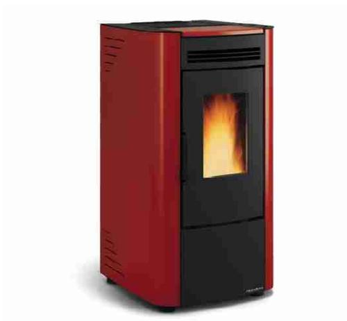
Stufa a pellet La Nordica + Extraflame "Ketty 5.0" bordeaux 6,5 kW. Stufa a pellet con potenza 6,5 kW, dotata di display black LCD. Questo strumento è ideale per riscaldare efficientemente la propria abitazione, fino a 187 mc. Realizzata con porta fuoco, focolare e braciere in ghisa. Stufa munita di scambiatore di calore a superficie radiante e vano cenere estraibile. La.....**Altro**
