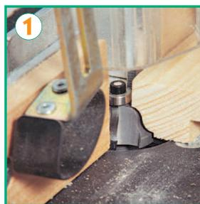
**1:** con la fresatrice da banco si ottengono facilmente la scanalatura centrale e le modanature laterali dei reggimensola.
