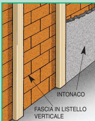
Prepariamo delle "fasce" con listelli dello spessore dell'intonaco finito applicati in verticale alla parete. Serviranno per rasare l'intonaco con uno spessore costante.
