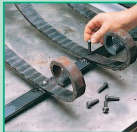
I prefiniti vanno allineati e forati in corrispondenza del punto di fissaggio, da effettuare con ribattini ed eventualmente rinforzare con una saldatura nei punti d'incrocio.
