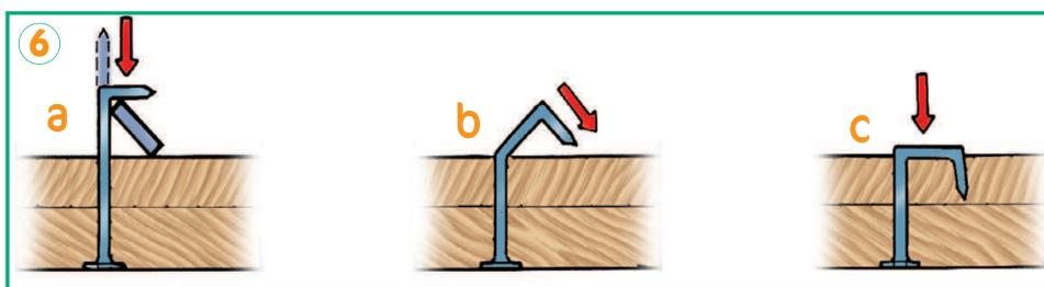
**6:** se si è costretti ad utilizzare chiodi troppo lunghi, che quindi sporgono dall'altra parte, dobbiamo provvedere a ripiegare la punta. Per farlo correttamente utilizziamo una barretta metallica in modo da creare un angolo di 90° (a). Poi si ribatte il chiodo (b) in modo da conficcare la punta nel legno (c).
