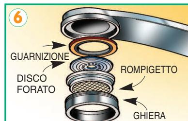
**6:** il rompigetto a reticella è trattenuto da una ghiera a vite e preceduto da un disco forato e una guarnizione di tenuta.
