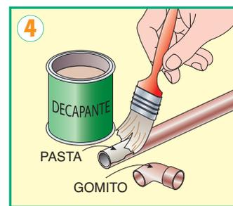
**4:** l'applicazione della pasta decapante garantisce la penetrazione e l'adesione del materiale d'apporto.
