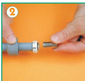
**2**: si inserisce la ghiera a vite, l'ogiva conica e il cannotto metallico.
