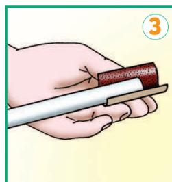
**3**: si leviga con carta abrasiva per irruvidire il tubo.
