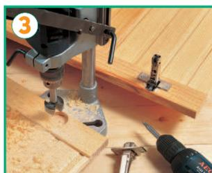
**3:** sui montanti delle ante pratichiamo i fori in cui inserire le teste delle cerniere a braccio.
