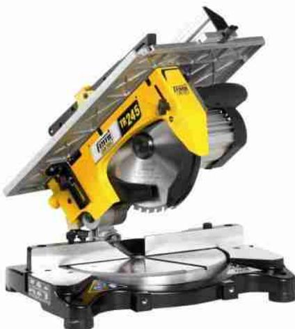
Troncatrice per legno e alluminio "TR245" con piano superiore e diametro 254 mm, 1200 W - FemiTroncatrice per legno e alluminio realizzata da una struttura in alluminio pressofuso. Dotata di un motore ad induzione 1200 W potente e silenzioso, con piano superiore di 360x462 mm. Dispone di una capacità di taglio di 162 mm, di un taglio massimo di 162x75 mm e di un angolo di.....**Altro**
