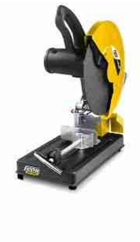
Troncatrice per metalli con disco abrasivo diametro 355 mm, 2000 W - FemiTroncatrice per metalli con potente motore universale 2000 W per una maggiore velocità di taglio ed una regolazione di velocità. Dispone di trasmissione realizzata con ingranaggio elicoidale montato su cuscinetto e 3000 RPM. È dotato di disco abrasivo con diametro 355 mm per metalli ferrosi, morsa.....**Altro**
