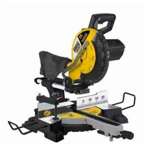
Troncatrice radiale "TR1025/A" con diametro lama 254 mm, 2200 W - FemiTroncatrice radiale con potente motore 2200 W, leggera e trasportabile. Dispone di angolo di taglio con blocco automatico a 0°-15°-33,30°-30°-45°. È dotata di ampia capacità di taglio 305x70 mm, supporto poggia pezzo con scala graduata e puntatore laser. Presenta un diametro lama di.....**Altro**
