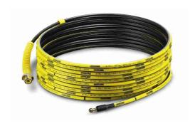
Accessorio idropulitrice Karcher set sturatubi 15 m.Per liberare tubazioni e scarichi otturati. Getti ad alta pressione rivolti indietro spingono lil tubo dello sturatubi all'interno del tubo otturato liberandolo. Gli indicatori colorati sul tubo indicano l'avanzamento dello sturatubi nella conduttura. Prodotti compatibili: G 4.10 M / G 4.10 M / G 7.10 M / G 7.10 M / K 2 Basic / K 2.......Altro
