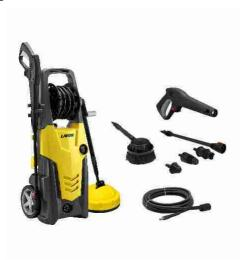
Idropulitrice elettrica a freddo multiaccessoriata Lavorwash "Planet 160" 160 bar 510 l/h 2500 w.ldropulitrice a freddo Planet 160, con potenza di 2500 Watt, pressione dell'acqua di 160 bar e 510 L/H. Idropulitrice ad acqua fredda con pompa assiale, testata in alluminio a tre pistoni in acciaio ad alta resistenza con valvola di by-pass incorporata, dotata di vano porta accessori,........Altro
