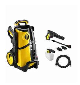
Idropulitrice elettrica a freddo Lavorwash "LVR3 140" 140 bar 450 I/h 1900 w.Idropulitrice LVR3 140 con gruppo pompa assiale, testata in alluminio a tre pistoni in acciaio ad alta resistenza con valvola di bypass incorporata. Vano porta accessori. Supporto porta cavo elettrico. AUTOMATIC STOP SYSTEM che consente l'attivazione o stop totale della macchina azionando la leva della.......Altro
