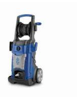
Idropulitrice elettrica a freddo Annovi Reverberi "4 Series 492" 150 bar 450 l/h 2100 w.ldropulitrice con carrello a due ruote completo di manico. Pompa a tre pistoni assiali comandati dal piattello oscillante, testa in alluminio. I pistoni sono realizzati in acciaio inossidabile temprato per garantire la massima resistenza nel.......Altro
