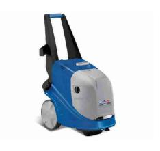
Idropulitrice elettrica a caldo Annovi Reverberi "35 Series" 150 bar 450 l/h 2400 w.ll modello 35 Series è un'idropulitrice ad acqua calda semi-professionale dotata di accessori professionali per rimuovere sporco ostinato come olio e grasso. La pompa a 3 pistoni in acciaio temprato fornisce una potenza di 2,4 kW, una portata di 480 l/h e una pressione di 140 bar. La caldaia..........Altro
