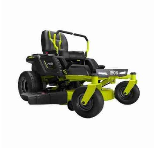
Il trattorino rasaerba Ryobi ZTR480EX a raggio zero è un prodotto **estremamente innovativo e tecnologicamente all'avanguardia**. Questo trattorino è alimentato da **4 motori Brushless** di ultima generazione alimentato da 4 batterie per un totale di 48V e 100Ah che garantiscono **un'autonomia di lavoro fino a 2 ore e mezza** sufficienti per tagliare superfici fino a.....**Altro**
