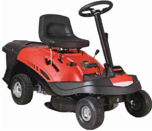
Il trattorino tagliaerba Rider Sandrigarden monta un potente motore 4 tempi OHV da 196 cc ed ha un diametro di taglio di 61 cm. Il trattorino viene fornito con pratico cesto di raccolta posteriore con capienza di 150 litri. L'altezza di taglio è facilmente regolabile tramite l'apposita leva in 5 posizioni da 35 a 75 mm. La velocità di avanzamento è regolabile in 4 differenti.....**Altro**
