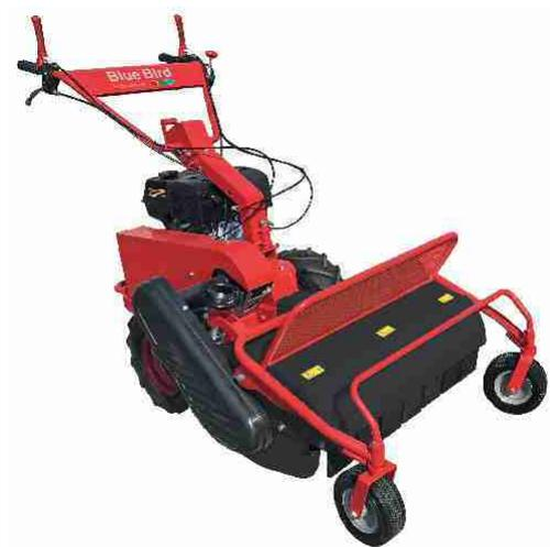
Trinciasarmenti a scoppio Blue Bird "FM 750" 4t 420 cc. Questa trinciasarmenti a scoppio è equipaggiata con un potente motore Loncin a 4 tempi da 420 cc, eroga 9,2 kW a 3600 rpm. Con una larghezza di taglio di 75 cm e un'altezza regolabile tra 20 e 80 mm, è ideale per interventi impegnativi di sfalcatura e rimozione di erbe alte e consistenti, di pulizia nel sottobosco o in.....**Altro**
