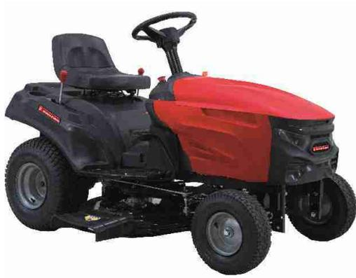
Trattorino tagliaerba con motore a scoppio Sandrigarden con potente motore 4 tempi da 352 cc e 7,9 HP. La larghezza di taglio è di 84 cm ed è ideale per tagliare superfici fino a 3000 m<sup>2</sup>. Il trattorino può essere utilizzato con la funzionalità di taglio scarico laterale o con la funzione mulching con il kit incluso. Le lame vengono attivate elettronicamente grazie al.....**Altro**
