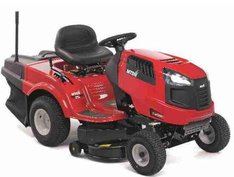
Trattorino tagliaerba con motore a scoppio MTD "Smart Re 125" in polipropilene con cesto di raccolta posteriore, 382 cc. Pratico e robusto, dotato di un affidabile motore MTD ThorX con una trasmissione trasmatica, questo trattorino rasaerba è un eccezionale strumento per la cura di aree da sino a 3500m<sup>2</sup>. Grazie al suo ridotto raggio di sterzata di 46 cm, permette di tagliare.....**Altro**
