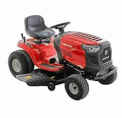
Trattorino tagliaerba Troy Bilt "Horse 107T-S" con scarico laterale e cambio idrostatico. Il trattorino rasaerba monta un potente motore bicilindrico da 679 cm<sup>3</sup> 13.1 kW e un piatto di taglio a doppia lama con larghezza di taglio di 107 cm. La trasmissione idrostatica permette di variare facilmente la velocità del trattorino grazie all'apposita leva. Questo trattorino dispone.....**Altro**
