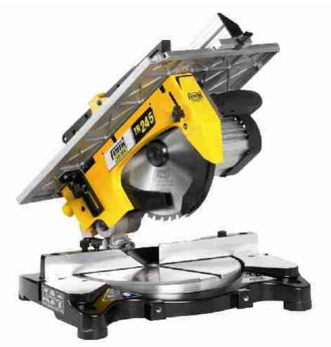
Troncatrice per legno e alluminio "TR245" con piano superiore e diametro 254 mm, 1200 W - FemiTroncatrice per legno e alluminio realizzata da una struttura in alluminio pressofuso. Dotata di un motore ad induzione 1200 W potente e silenzioso, con piano superiore di 360x462 mm. Dispone di una capacità di taglio di 162 mm, di un taglio massimo di 162x75 mm e di un angolo di.....**Altro**
