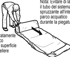
Ripiegare accuratamente il parco acquatico premendo sulla superficie in modo da espellere l'aria rimasta.
