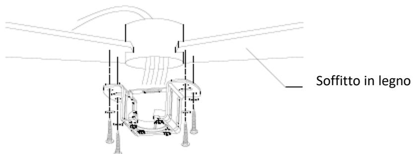
Fissare il braccio di sospensione al soffitto in legno con viti autofilettanti
