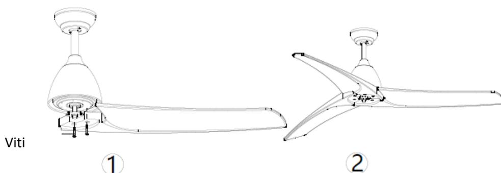
Le rondelle per le viti possono essere installate su ciascuna lama prima del montaggio
