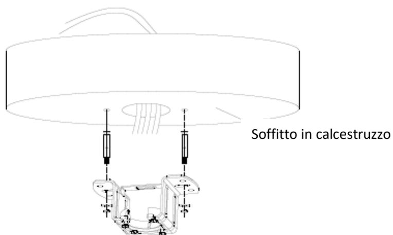
Fare con il trapano un foro dia 8 mm e inserire il bullone. Allineare il braccio al foro e fissare con il dado
