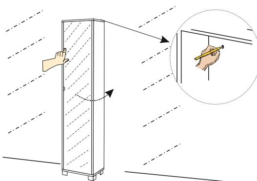
Posizionare il mobile in piedi ed adiacente alla parete alla quale lo si vuole fissare. Aprire l'anta. Internamente, con un trapano effettuare due fori sulla schiena, quindi con una matita, segnare i fori sulla parete. **ATTENZIONE: trattenere il mobile con una mano onde evitare la caduta.**
