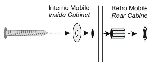
Riposizionare il mobile alla parete ed aprire l'anta. Internamente, inserire la vite (fig. 5-d) nella rondella (fig. 5-c) e l'insieme nel foro dentro il mobile, poi sul retro, inserire la vite nel distanziale (fig. 5-b) ed inserirlo nel foro sul muro. Ripetere l'operazione per l'altro foro, ed avvitare con il cacciavite sino a completarne il fissaggio. **ATTENZIONE: durante questa operazione trattenere il mobile con una mano onde evitare la caduta.**
