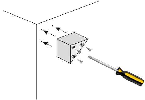
Posizionare ora il piede (fig.1) sui fori segnati sull'angolo della base come mostrato in figura. Fissare il piede con le viti 4,5x16 (fig.2) (3 viti per piede). Ripetere l'operazione sugli altri angoli con i restanti piedi.
