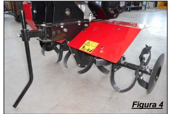
**Figura 3:** fissare il ruotino premontato al telaio e montare il paraurti in posizione anteriore. Fissare al telaio il supporto sperone e a quest'ultimo il braccio, usando il perno in dotazione. Regolare l'altezza dello sperone sfruttando la vite.
