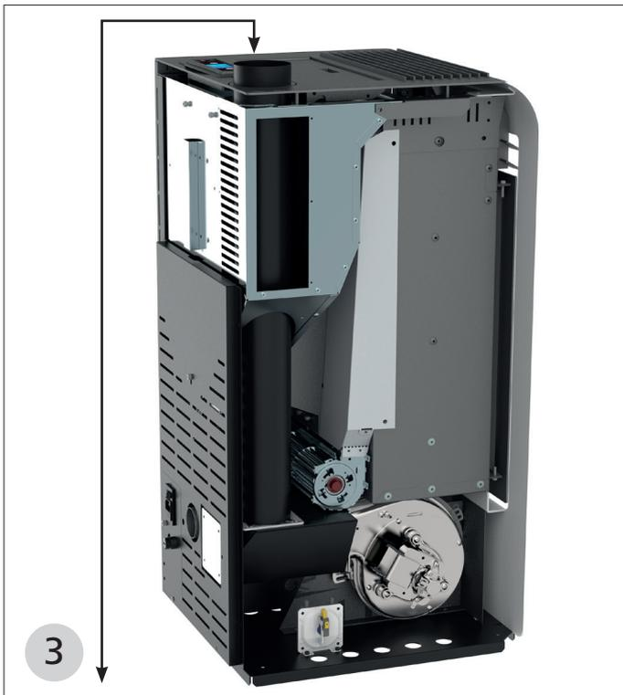
Romper il pre-tranciato del top e collegare il tubo verticalmente uscendo nella parte superiore della stufa. È fondamentale che il tubo non entri in contatto con le parti del serbatoio e garantire il passaggio d'aria tra serbatoio e tubo.
