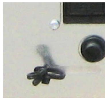
**Termostato ambiente:** il termostato ambiente rileva la temperatura presente nella stanza. Quando esso rileva la temperatura prestabilita sul display, la stufa si pone in funzionamento ECO ossia in funzione di mantenimento a risparmio di combustibile. Il termostato ambiente va steso in modo da non subire condizionamenti dalla temperatura del corpo stufa.
