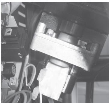
**Motoriduttore:** se il motoriduttore si ferma, la stufa continua a funzionare fino a quando non si spegne la fiamma per mancanza di combustibile e fino a che non raggiunge il livello minimo di raffreddamento.
