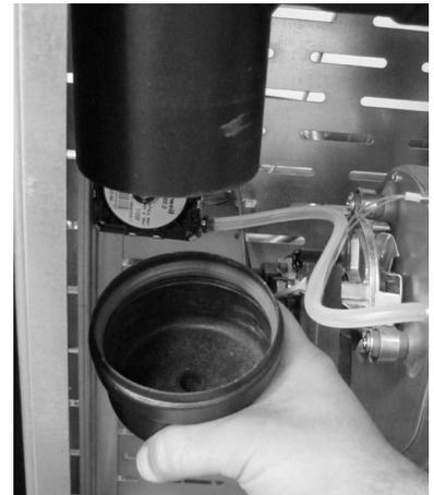
Ripulire il bicchiere dai residui accumulatisi durante il funzionamento della stufa.
