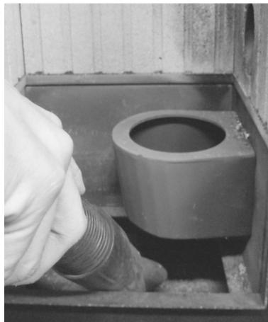
Rimuovere il pavimento della camera di combustione aiutandosi con un cacciavite e pulire sotto la piastra con un aspiratore.
