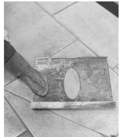
Rimuovere il battifiamma superiore sfilandolo a mano aperta verso di se e aspirare la parte superiore e inferiore del battifiamma.
