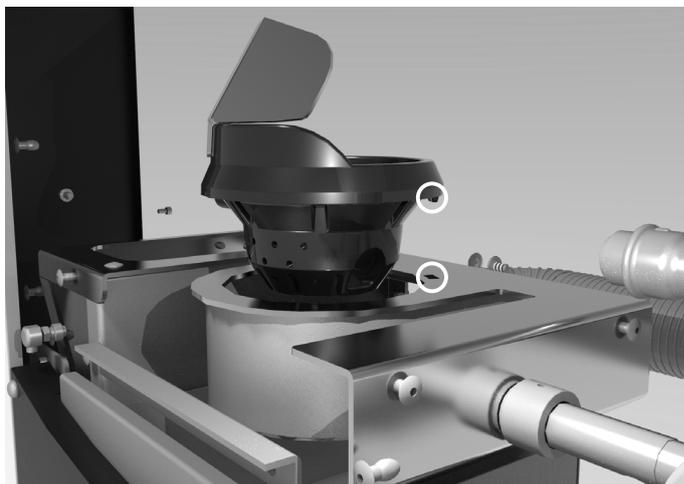
È altrettanto importante posizionare correttamente lo spoiler del braciere. Deve obbligatoriamente essere posizionato come mostrato nella seguente foto. Un posizionamento diverso potrebbe impedire la caduta del pellet all'interno del braciere.
