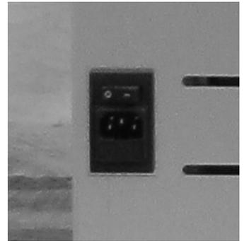
**Sicurezza elettrica:** la termostufa è protetta contro gli sbalzi violenti di corrente (es. fulmini) da un fusibile generale a 4 A che si trova nel pannello comandi posto sul retro della termostufa vicino al cavo di alimentazione. Altri fusibili per la protezione delle schede elettroniche sono situati su quest'ultime.
