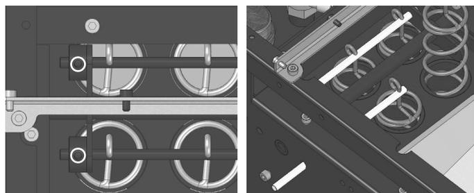
Ripetere la stessa operazione con le altre tre molle presenti. Ora la sezione superiore allo scambiatore di calore è sgombra da qualsiasi ingombro in modo da permettere una perfetta pulizia.
