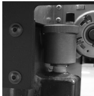
**Valvola di sfiato automatica:** questa valvola elimina l'aria all'interno della termostufa e dell'impianto di riscaldamento
