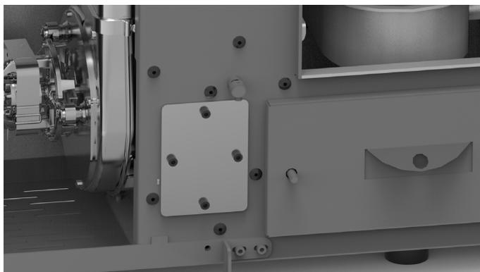
Svitare quindi le viti della piastra ispezione e rimuoverla. Con un aspiratore rimuovere tutto il residuo che si è depositato. Sostituire la guarnizione e rimettere la piastra.
