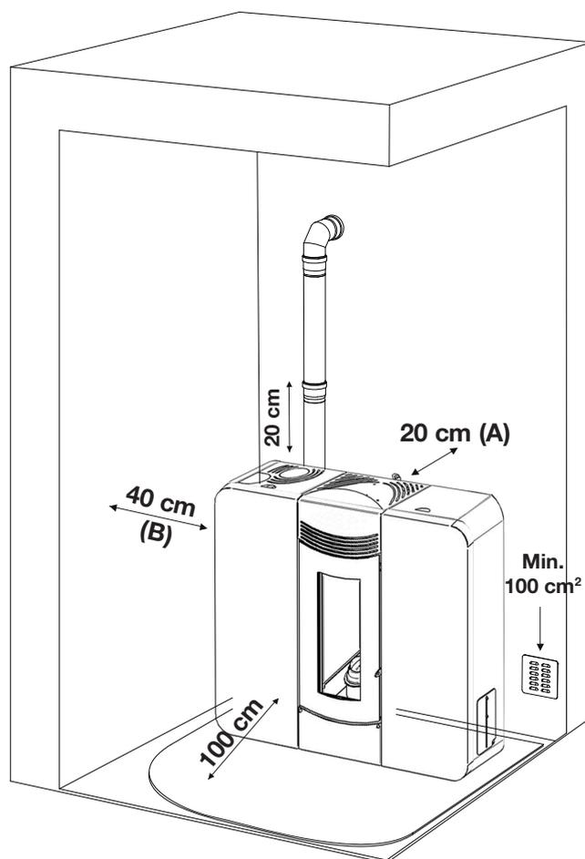
*Distanze da considerare per l'installazione di Stufe, Termostufe, Inserti camino acqua e aria.*
