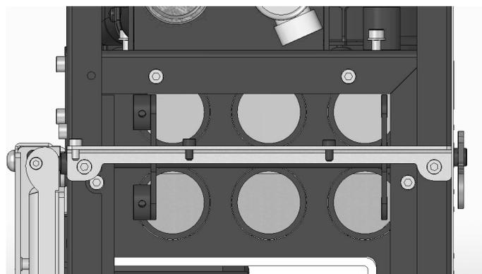
Per completare la pulizia dello scambiatore è necessario pulire anche il vano ispezione, posizionato a sinistra della camera di combustione, sotto le molle. Rimuovere i componenti estetici che ne impediscono l'accesso (ad esempio il fianco).
