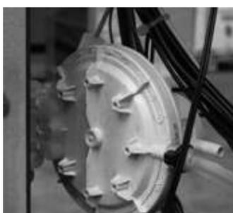
**Pressostato fumi:** controlla la pressione nel condotto fumario. Esso provvede a bloccare la coreda di caricamento pellet nel caso lo scarico sia ostruito o ci siano contropressioni significative ad esempio in caso di presenza di vento, di porta della camera di combustione aperta o guasto dell'estrattore fumi. Nel momento di intervento del pressostato apparirà la scritta **ALAR-DEP-FAIL**.
