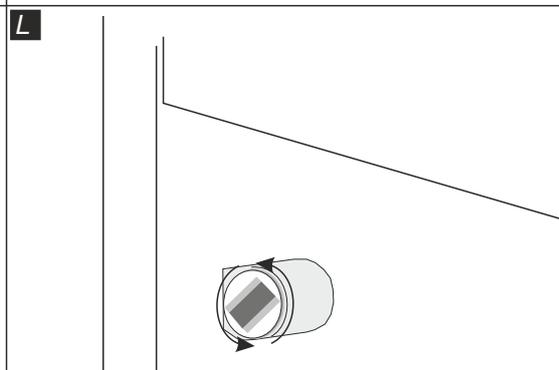
Se necessario migliorare la chiusura delle ante, agire con le dita sulle calamite di sicurezza dentro il mobile, avvitando e svitando.
