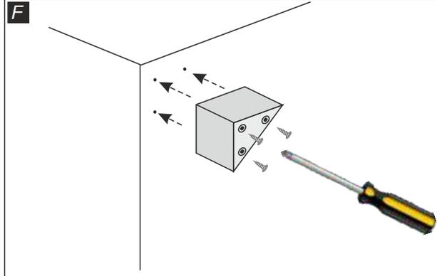
Posizionare ora il piede (fig.1) sui fori segnati sull'angolo della base come mostrato in figura. Fissare il piede con le viti 4,5x16 (fig.2) (3 viti per piede). Ripetere l'operazione sugli altri angoli con i restanti piedi.
