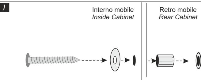
Riposizionare il mobile adiacente alla parete ed, internamente alla prima anta in alto, inserire la vite (5-d) nella rondella (5-c), e l'insieme nel foro sulla schiena, quindi sul retro, inserire la vite nel distanziale (5-b) ed inserirlo nel foro sul muro (stessa operazione con l'altro foro). Quindi fissare le viti alla parete. **Attenzione: trattenerne il mobile durante questa operazione onde evitarne la caduta.**
