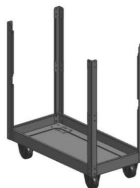
3. Inserire il vassoio centrale fra le quattro colonne, fissare il giunto con le viti e i dadi.
