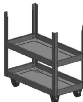
Installare il vassoio superiore alle quattro colonne, fissare i giunti con le viti e i dadi.
