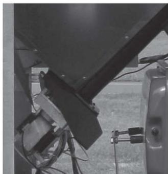
**Motoriduttore:** se il motoriduttore si ferma, l'Inserto Camino continua a funzionare fino a quando non si spegne la fiamma per mancanza di combustibile e fino a che non raggiunge il livello minimo di raffreddamento.
