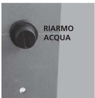
**Termostato di sicurezza a riarmo manuale per la temperatura dell'acqua:** se la temperatura dell'acqua supera il valore di sicurezza impostato a 100° C si arresta immediatamente il funzionamento dell'Inserto Camino e sul display apparirà la scritta **"ALAR-SIC-FAIL"**. Per riavviarlo è necessario ripristinare il termostato manualmente.
