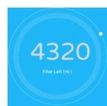
Sur la page principale de l'application apparaît une figure concentrique, le compte à rebours des heures restantes avant de procéder au remplacement du filtre durant le fonctionnement s'affiche alors (total heures initiales: 4 320 heures)
