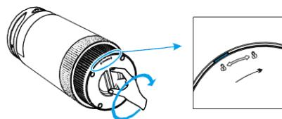
Sostituire il filtro solo con il ricambio originale, dopo circa 4320 ore di funzionamento.
