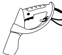
Fije la conexión de la barredora al prolongador de cable insertándolo en el gancho de sujeción del manillar y enchúfelo a la máquina
