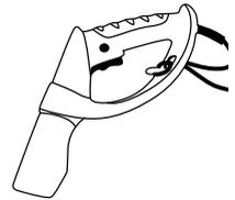
Fixez la connexion de la machine au prolongateur du câble en l'insérant dans l'encoche de la poignée et branchez-le à la machine.
