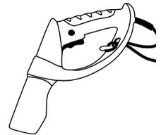
Fije la conexión de la barredora al prolongador de cable insertándolo en el gancho de sujeción del manillar y enchúfelo a la máquina
