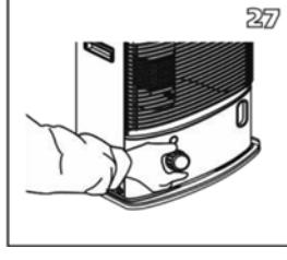
15. Far scivolare il gruppo di regolazione dello stoppino giù nell'aspiratore. Posizionare il dispositivo di regolazione nella parte anteriore della stufetta.
