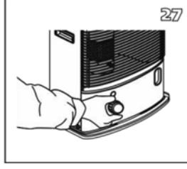
15. Deslice el regulador de mecha hacia abajo por el conducto de ventilación. Coloque el botón de regulación de mecha en la parte delantera de la estufa.
