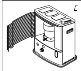
Si ha sacado la parte izquierda de la rejilla, inserte primero el pivote de la parte superior izquierda en la ranura, y luego inserte el pivote inferior izquierdo en su ranura (fig. E).
