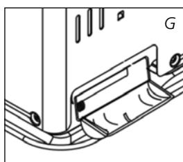
**4** Coloque las pilas en su alojamiento **11** situado en la parte posterior de la estufa (fig. G). Observe los polos + y -. Coloque la tapa del compartimento de la batería.
