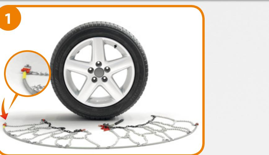
Si raccomanda di indossare giubbotti ad alta visibilità (giubbino di segnalazione) durante il montaggio. Distendere la catena in ordine a terra, assicurandosi che il terminale giallo del cavo sia rivolto a sinistra
