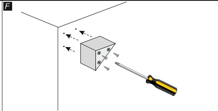
Posizionare ora il piede (fig.1) sui fori segnati sull'angolo della base come mostrato in figura. Fissare il piede con le viti 4,5x16 (fig.2) (3 viti per piede). Ripetere l'operazione sugli altri angoli con i restanti piedi.
