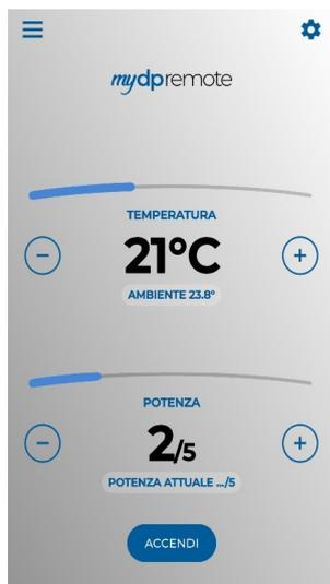
10. L'applicazione è ora connessa al modulo WiFi della stufa. Se ciò non avvenisse rieseguire la configurazione dell'applicazione controllando con attenzione i dati inseriti. Consultare eventualmente il **Par. 12** per la risoluzione dei problemi più frequenti
