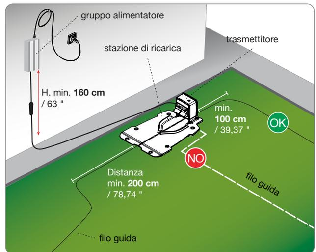
In caso di installazione del robot vicino ad un'area in cui è installato un altro robot (uguale o di un diverso produttore) si dovrà effettuare, in fase di installazione, una modifica al trasmettitore e ricevitore del robot in modo che le frequenze dei due robot non si disturbino a vicenda.
