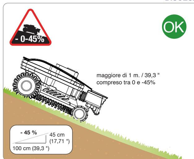
Il robot è in grado di affrontare dislivelli con inclinazione sino a 45% purché degradino in una distanza superiore al metro.
