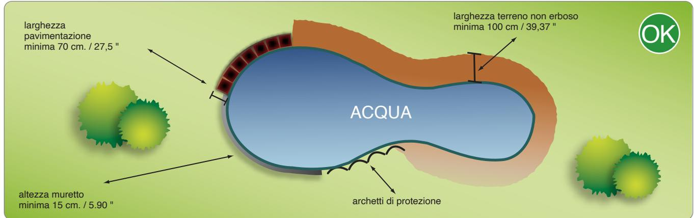
La figura sopra rappresenta un'area di lavoro correttamente delimitata per un ottimo funzionamento del robot.
