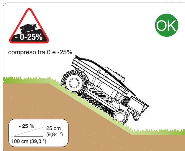
Il robot è in grado di affrontare dislivelli con inclinazione sino a 25% nel caso in cui degradino in maniera repentina.
