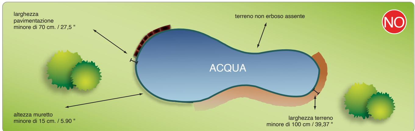
La figura sopra rappresenta un'area di lavoro dove le zone operative del robot non sono state correttamente delimitate impedendo il regolare funzionamento del robot.
