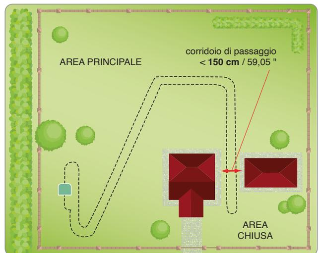
Se all'interno dell'area di lavoro è presente una pavimentazione di tipo metallico o se è presente un tombino metallico, un piano doccia o dei cavi elettrici, sistemare il filo guida ad almeno 100 cm (39,37") per evitare malfunzionamenti del robot e disturbi sul filo guida.
