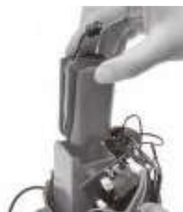
3. Abra a tampa da bateria, localize o cabo de conexão, pressione o clipe do conector, retire-o e extraia a bateria.
