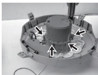
2. Utilizzare un cacciavite per rimuovere tutte le viti sul coperchio dell'alimentazione del coperchio inferiore.
