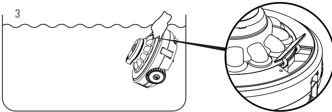
Sie können den Roboter daran einfach aus dem Wasser heben.
