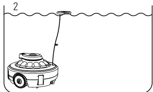
Pas de lengte van het touw aan om ervoor te zorgen dat de lengte van het touw gelijk is aan het waterniveau, en dat de overtollige lengte van het touw wordt vastgeknoopt of ingekort.
