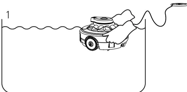
Zet de schakelaar aan, maak het touw aan de drijver los, plaats de robot horizontaal in het zwembad en wacht tot de robot vrij naar de bodem zakt. (als het apparaat niet in het water wordt geplaatst, zal de motor niet draaien omdat het is voorzien van de functie «stoppen buiten het water»).
