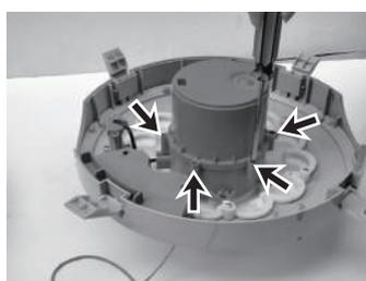
2. Retirez toutes les vis du couvercle de la batterie de la partie inférieure avec un tournevis.
