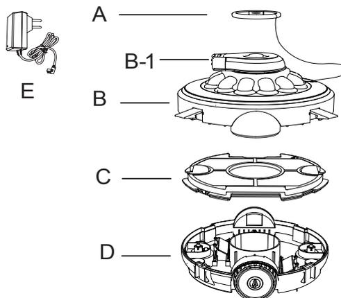
Sulla copertura superiore è presente la l'elemento di rotazione della testa a getto, l'acqua sta passando dalla parte inferiore alla testa a getto per fare muovere il robot. Quando trova un ostacolo, la testa del getto ruota di 180 gradi, il robot aggira l'ostacolo e si sposta di un'altra linea. La sporcizia viene raccolta e introdotta nell'alloggio del filtro posteriore.
