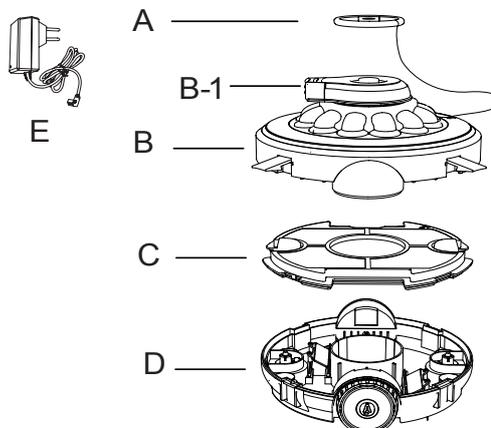
El cabezal del chorro se encuentra en la cubierta superior. El agua pasa desde la parte inferior hasta el cabezal para que el robot avance. Cuando se encuentra con un obstáculo, el cabezal gira 180°, lo que hace que el robot esquive el obstáculo y se desplace por otra línea. El filtro inferior recoge y almacena los desperdicios en un recipiente.
