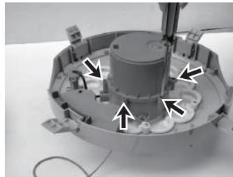
2. Entfernen Sie alle Schrauben des Batteriefachdeckels mit einem Schraubenzieher.
