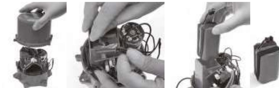
3. Open de accudeksel, zoek de batterij-aansluitkabel, druk op de clip op de stekker, trek hem eruit en verwijder de accu.
