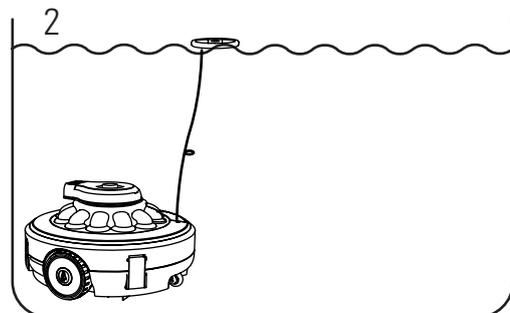
2. Ajuste la longitud de la cuerda para asegurarse de que está a la misma altura que el nivel del agua y ate o corte la cuerda sobrante.
