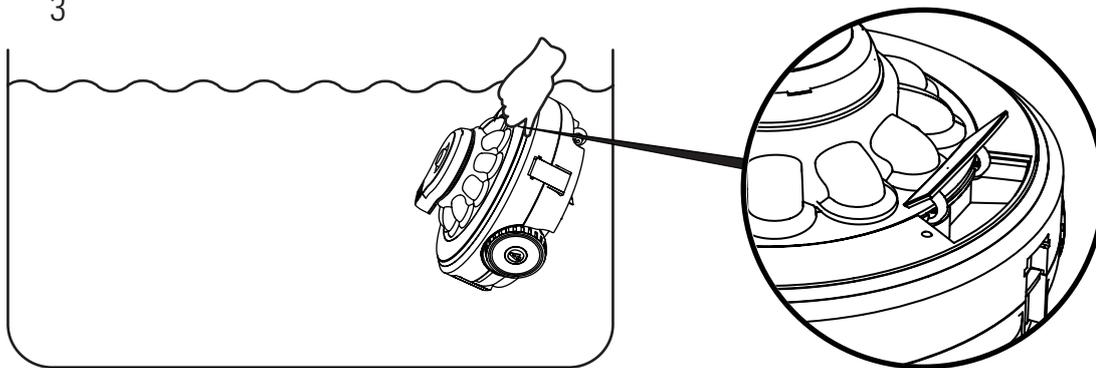
Aprire questo alloggiamento manualmente ed estrarre facilmente il robot
