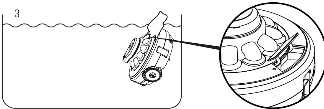
Abra esta trampilla para sujetar el robot y extraerlo con facilidad
