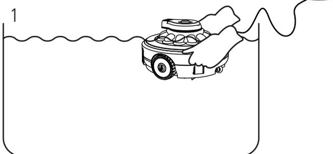
Schalten Sie den Schalter an, lösen Sie das Seil am Schwimmer, platzieren Sie den Roboter horizontal im Pool und warten Sie, bis er auf den Poolboden sinkt. (Wenn sich der Roboter nicht im Wasser befindet, dreht er sich nicht, da er so programmiert sich, dass er sich nur im Wasser dreht.)
