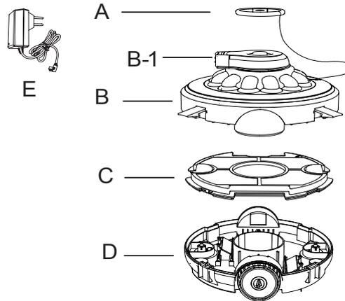
Er zit een roterende straalkop aan de bovenklep, het water stroomt van de onderkant naar de straalkop om de robot in beweging te brengen. Als hij naar een obstakel tegenkomt, draait de straalkop 180 graden en beweegt de robot langs een andere lijn rond het obstakel. Het vuil wordt verzameld en opgeslagen doordat de onderste filterkamer.
