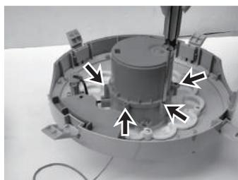
2. Con un destornillador, suelte todos los tornillos de la cubierta de la batería de la parte inferior.
