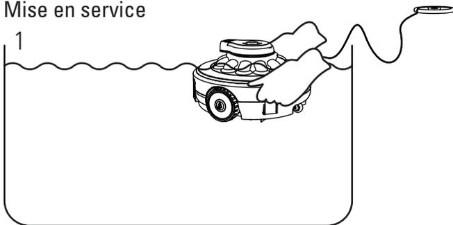
Appuyez sur l'interrupteur, lâchez la corde du flotteur, placez le robot en position horizontale dans la piscine et attendez que ce dernier atteigne seul le fond du bassin (si le dispositif n'est pas introduit dans l'eau, la machine ne tourne pas, étant donné qu'elle possède une fonction spécifique d'arrêt si elle n'est pas immergée dans l'eau).
