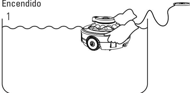
1. Pulse el interruptor, suelte la cuerda del flotador, coloque el robot en posición horizontal dentro de la piscina y espere a que se sumerja por sí mismo hasta el fondo. (Si el dispositivo no se introduce en el agua, la máquina no rota porque cuenta con una función específica de detención si no está en el agua).
