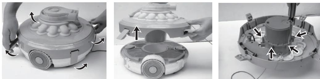
2. Gebruik een schroevendraaier om alle schroeven van de stroomafdekking op de afdekking van de onderkant te verwijderen.
