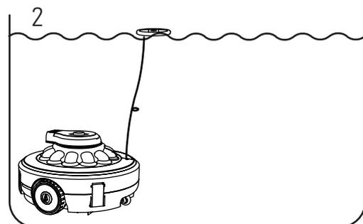
Ajuste o comprimento da corda para se assegurar de que esta está à altura do nível da água, e ate ou corte a corda sobranete.
