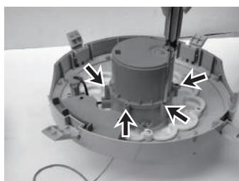
2. Com uma chave de parafusos, desaperte todos os parafusos da tampa da bateria situada na parte inferior.
