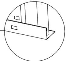
Unione: Sormontare ai profili di fissaggio dei 2 pannelli separati, il profilo di giunzione in modo da unirli. Eseguire la stessa operazione sia per le parti laterali che per quelle angolari
