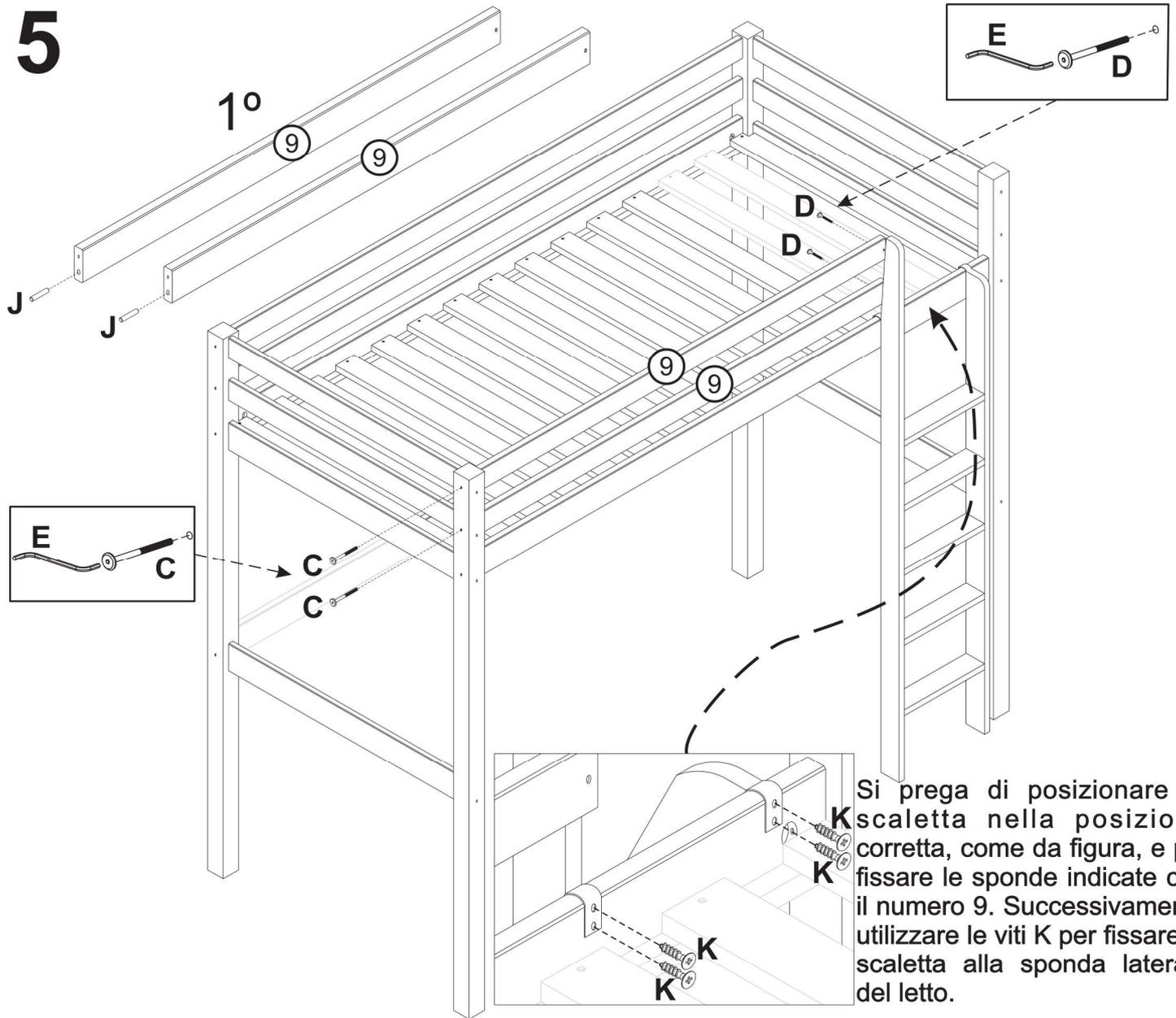
Si prega di posizionare la scaletta nella posizione corretta, come da figura, e poi fissare le sponde indicate con il numero 9. Successivamente utilizzare le viti K per fissare la scaletta alla sponda laterale del letto.
