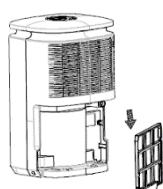
Extrayez le réservoir, déboîtez le filtre vers le bas et sortez-le. Pour nettoyer le filtre, utilisez seulement de l'eau à température ambiante: ne pas utiliser d'eau chaude, de produits de nettoyage, solvants, tampons abrasifs ou autre. Essuyez soigneusement le filtre (ne pas utiliser de l'eau chaude), puis réinsérez-le correctement à son emplacement.
