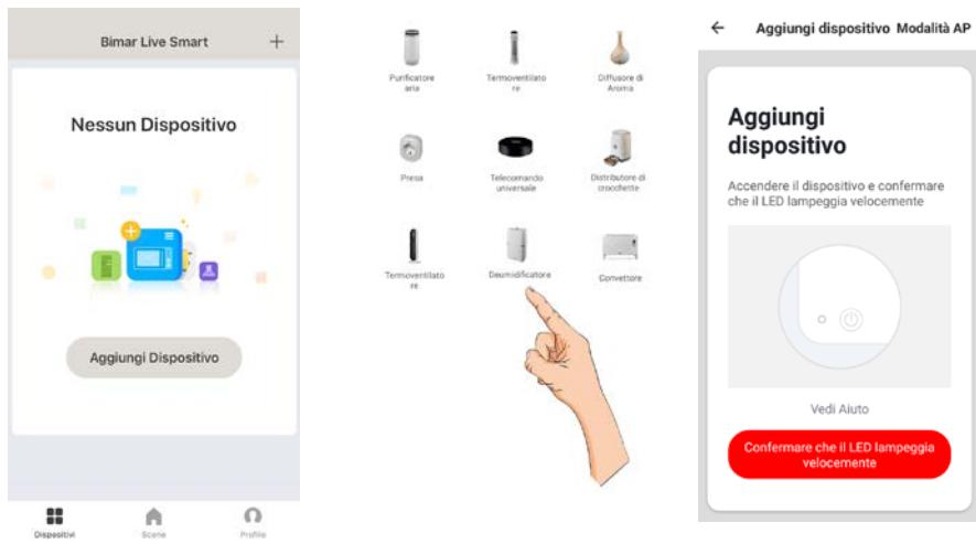
Das Gerät kann auch über den „AP-Modus“ gekoppelt werden. Drücken Sie hierfür die Taste oben rechts; drücken sie die Taste „
