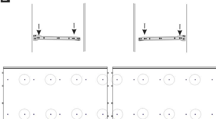
Fissare sulle tramezze (5) le guide cassetto (14) con le viti 6,3x13 (15).
