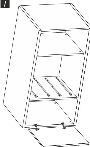
Ruotare il mobile appoggiano un fianco su una superficie piana, quindi posizionare l'anta (5) adiacente al fianco con i fori delle cerniere ai rispettivi fori sul fianco. Inserire e fissare le cerniere (17) nei fori posti sull'anta e sul fianco ed avvitare come mostrato in figura. Capovolgere il mobile e ripetere l'operazione per fissare l'altra anta.
