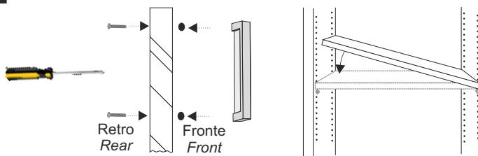
Posizionare in piedi il mobile. Fissare ora le maniglie (12) alle ante e cassetti con le viti 4x20 (13). Inserire il ripiano inclinato (8) sui reggipiani (25) inseriti precedentemente sui fianchi e tramezze, quindi riportare in posizione orizzontale il ripiano.
