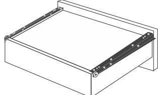
Capovolgere il cassetto e fissare le guide cassetto (14) sui bordi dx e sx sul fondo del cassetto con le viti 3,5x20 (16). Le guide vanno poste con le ruote rivolte verso l'esterno e retro del cassetto.
