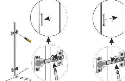
Se l'apertura/chiusura delle ante non è perfetta, è necessario agire con il cacciavite sulla vite posta al centro delle cerniere, avvitando e/o svitando leggermente. In relazione al senso di rotazione della vite sulla cerniera, l'anta si avvicina o allontana dal fianco del mobile.
