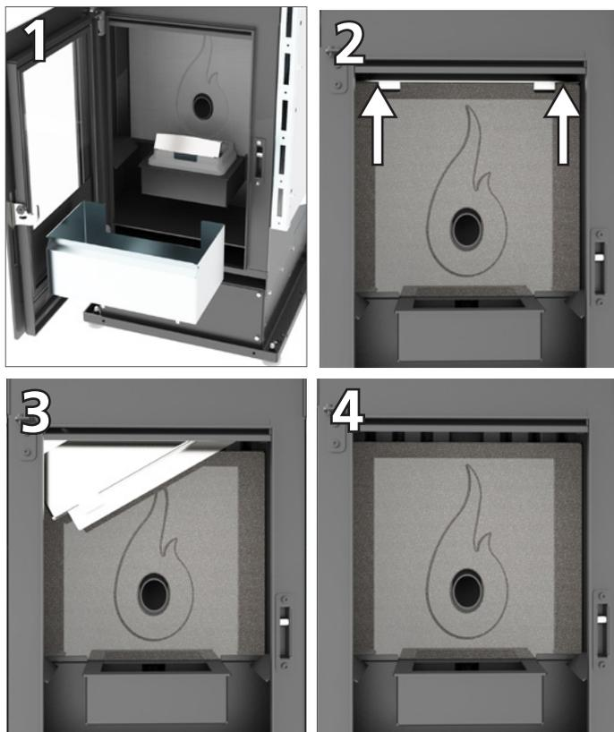
Spingere ora il refrattario verso l'alto (foto 4 + foto 5), ruotarlo (foto 6) e sfilarlo dalla camera di combustione.
