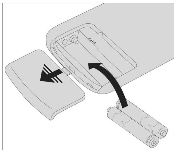
**SE IL TELECOMANDO È SPENTO PER ASSENZA DI BATTERIE, È POSSIBILE COMANDARE LA STUFA DAL PANNELLO COMANDI, POSTO NELLA PARTE SUPERIORE DELLA STUFA. DURANTE L'OPERAZIONE DI SOSTITUZIONE PRESTARE ATTENZIONE ALLE POLARITÀ SEGUENDO LA SIMBOLOGIA IMPRESSA SUL VANO INTERNO DEL TELECOMANDO.**
