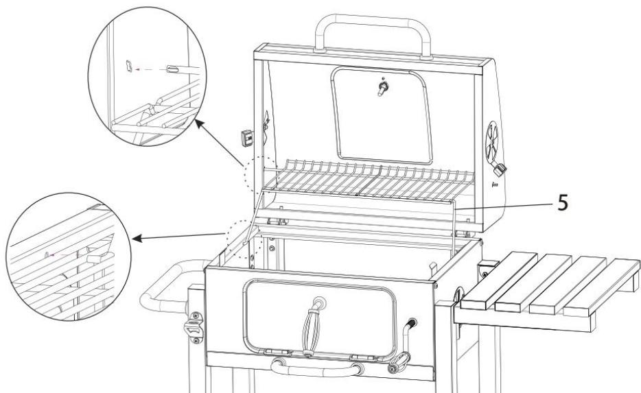
**20<sup>o</sup> PASSAGGIO:** Posizionare le griglie di cottura (6) all'interno del barbecue
