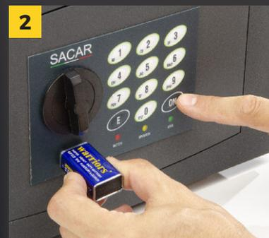
prima attivazione, ma anche successivamente, nel caso si esauriscano le batterie interne. **2** Tenendo in contatto la batteria sui terminali, si digita il codice principale o il personale preimpostati dalla fabbrica e si preme il tasto ON per sbloccare la serratura.
