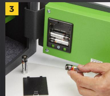
**3** Ruotando la manopola in senso orario si apre lo sportello. In questo modo si ha accesso al vano delle batterie, alloggiato nella faccia interna dello sportello stesso. Si inseriscono quattro pile alcaline da 1,5 volt, in formato AA LR6, non incluse nella confezione.
