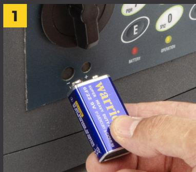
**1** La prima apertura della cassaforte va effettuata appoggiando la pila da 9 volt, inclusa nella confezione, sugli appositi contatti situati sulla tastiera, rispettando la polarità del contatto, indicata con "+" e "-". La batteria serve ad alimentare il sistema di apertura durante la
