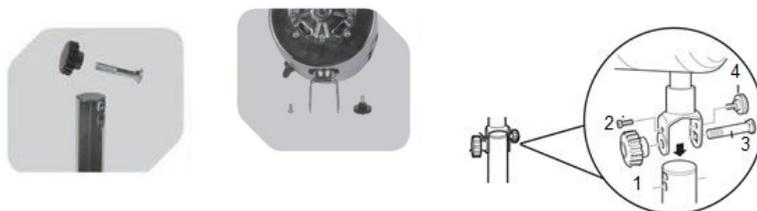
3. Posizionare il corpo motore sulla parte superiore del supporto.
