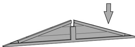
fissaggio con vite TSP Ø4,5x50
