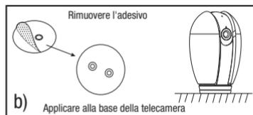
La tenacia dell'adesivo in dotazione consente di posizionare la telecamera a parete, soffitto o su un piano (per evitare che sia rimossa facilmente).
