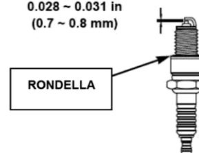
**NOTA:** Una candela allentata può surriscaldare e danneggiare il motore. Avvitare troppo la candela può danneggiare il filetto nella testata del motore.
