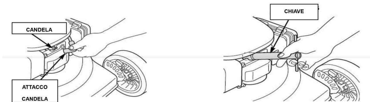
Controllare la candela. Sostituirla se gli elettrodi sono usurati, o se l'isolatore è rotto o scheggiato.
