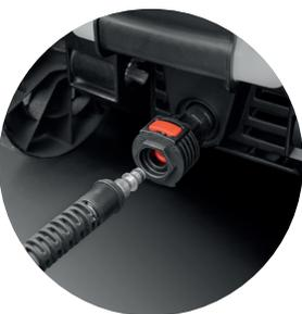
Attacco rapido tubo alta pressione/pompa: facilita e velocizza il riposizionamento del tubo alta pressione dopo l'uso.
