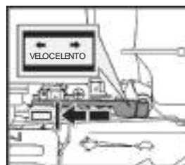
5. Tirare l'avviatore a strappo non all'accensione del motore. Riaccompanare il lo dell'avviatore alla posizione iniziale dopo ogni tentativo di avviamento. Ripetere i passi in base alla necessità. Una volta avviato il motore, portare l'acceleratore in posizione VELOCE, prima di procedere all'utilizzo dell'unità.
