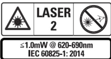
Seade STHT77100 kiirgab nähtavat laserikiirt, nagu näidatud joonisel A ①. Seadmest tulev laserikiir kuulub standardi IEC 60825-1 kohaselt 2. laseriklassi.
