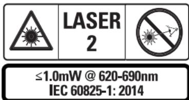
STHT77100 verktøyet avgir en synlig laserstråle som vist i Fig. A ①. Laserstrålens kilde er laserklasse 2 i henhold til IEC 60825-1.
