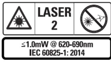
Model STHT77100 vysílá viditelný laserový paprsek, jak je zobrazeno na obr. A ①. Vysílaný laserový paprsek je laser třídy 2 dle směrnice IEC 60825-1.
