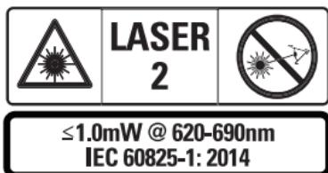
Инструментите STHT77100 излъчват видим лазерен лъч, както е показано на фигура А ①. Излъчваният лазерен лъч е лазерен клас 2, съгласно IEC 60825-1.
